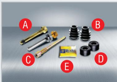
El Kit de Mordaza es un componente importante ya que de su buen estado depende el correcto funcionamiento del sistema de frenos de disco, se recomienda sustituir este elemento cada cambio de pastillas de freno. El Kit de Mordaza tiene como función principal soportar la mordaza del freno y al mismo tiempo permitir su desplazamiento según se esté aplicando la fuerza en el pedal del freno del vehículo, también según se vayan desgastando las pastillas de freno.
