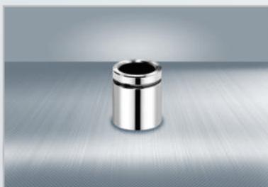
Los Pistones de Mordaza o Caliper son componentes muy importantes ya que de su estado depende el correcto funcionamiento del sistema de frenos de disco, se recomienda inspeccionar este elemento cada cambio de pastillas de freno y reemplazarlo cada dos cambios de pastillas de freno.
